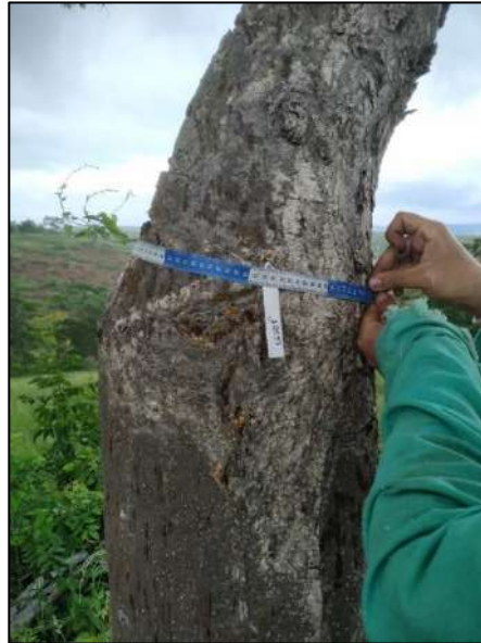
Figura 109 – Medição da Circunferência a Altura do Peito – CAP (circunferência a 1,30 m do solo) por meio de uma fita métrica.
