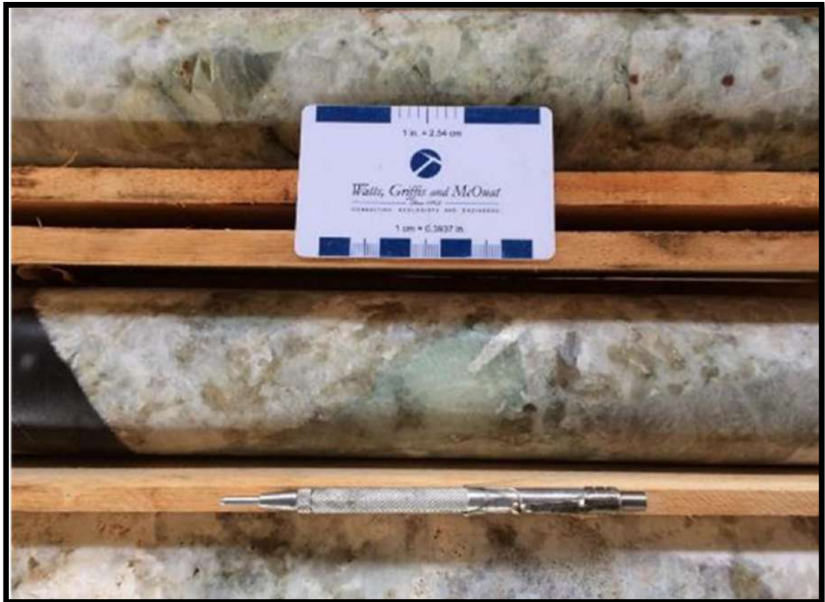
Figura 61 - Pegmatito em testemunho de sondagem, com destaque para espodumênio em coloração esverdeada. Fonte: Plano de Aproveitamento Econômico- GE21 Consultoria Mineral (2018).
